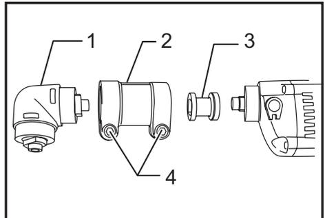
► 1. Angle housing 2. Joint 3. Socket 4. Bolt
