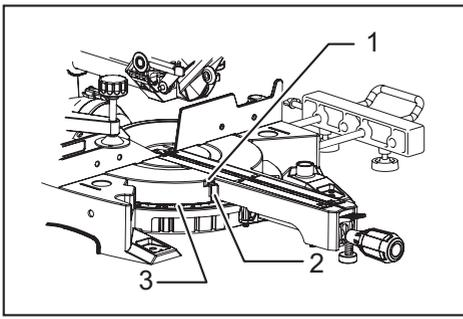
► 1. Screw 2. Pointer 3. Miter scale
