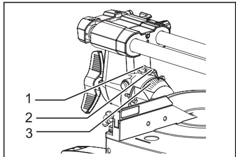
► 1. Screw 2. Pointer 3. Bevel scale
