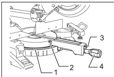
► 1. Miter scale 2. Pointer 3. Lock lever 4. Grip
