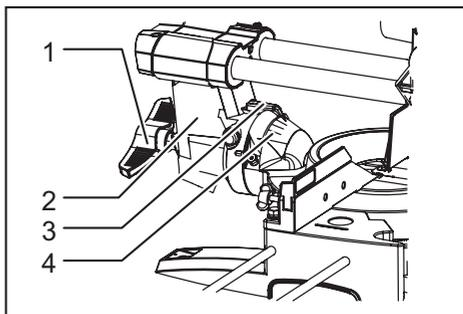
► 1. Lever 2. Arm 3. Pointer 4. Bevel scale
